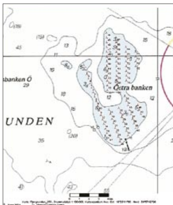
80 vindkraftverk utplacerade på max 10 meters djup på Östra banken
